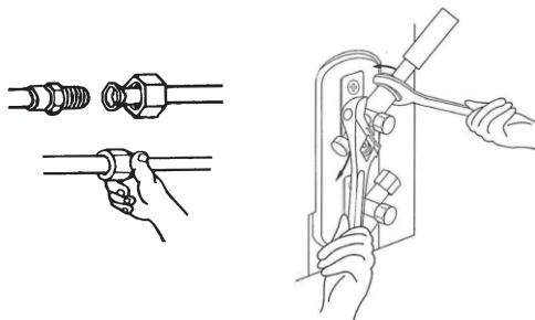
5. Tenendo saldamente il dado, utilizzare una chiave dinamometrica per serrare il dado svasato in base ai valori di coppia.
