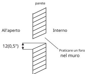
**NOTA:** Quando si esegue il foro nel muro, assicurarsi di evitare cavi, tubature e altri componenti sensibili. L'uscita del tubo di scarico deve trovarsi ad almeno 50 mm (1,9") dal suolo. Se tocca il suolo, l'unità potrebbe bloccarsi e funzionare male.
