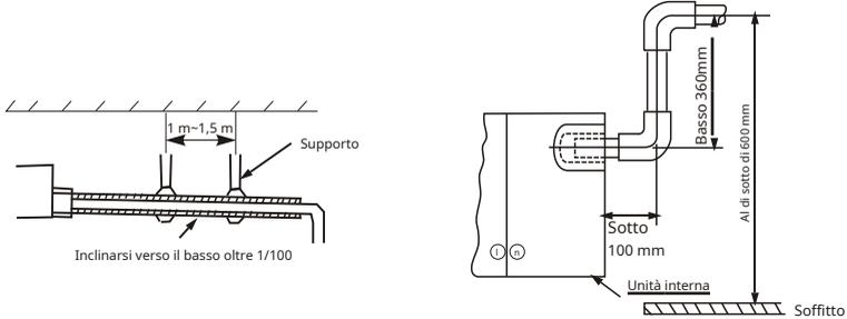
4. Utilizzando una carotatrice da 65 mm (2,5"), praticare un foro nel muro. Assicurarsi che il foro sia leggermente inclinato verso il basso, in modo che l'estremità esterna del foro sia più bassa dell'estremità interna di circa 12 mm (0,5"). Ciò garantirà il corretto drenaggio dell'acqua (come mostrato). Posizionare il bracciale protettivo da parete nel foro. Questo protegge i bordi del foro e aiuterà a sigillarlo al termine del processo di installazione.
