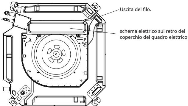
3. Collegare il cavo di alimentazione alla morsetteria. Il cablaggio dovrebbe adattarsi a quello dell'unità esterna.
