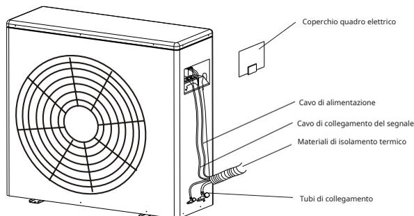
2. Collegare il cavo di alimentazione alla morsetteria. Il cablaggio dovrebbe adattarsi a quello dell'unità interna.
