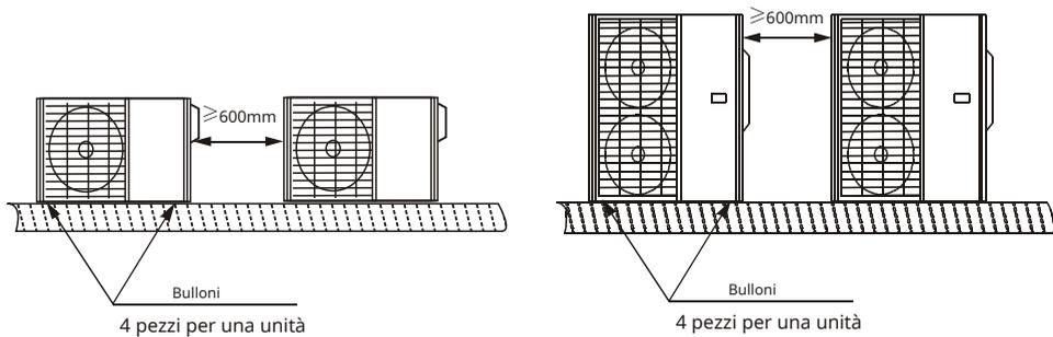
**NOTA:** La distanza minima tra l'unità esterna e le pareti descritta nella guida all'installazione non si applica ai locali stagni. Assicurarsi di mantenere l'unità non ostruita in almeno due delle tre direzioni (anteriore, sinistra, destra).
