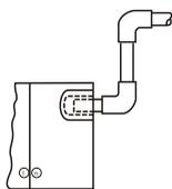
Installare il tubo di drenaggio
