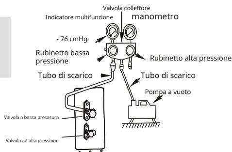
1. Collegare il tubo flessibile del manometro del collettore alla porta di manutenzione sulla valvola di bassa pressione dell'unità esterna.
