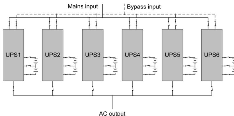
Stellen Sie sicher, dass sich jeder USV-Schalter in der Position "OFF" befindet und kein USV-Ausgang angeschlossen ist. Die Batteriepacks können separat oder parallel geschaltet werden, so dass die Anlage selbst sowohl eine Batterie für jede USV als auch eine einzige Batterie für alle USV zur Verfügung stellt.
