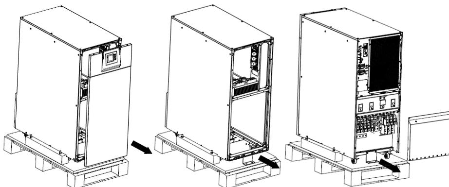
**Schritt 7** Verwenden Sie die im Paket enthaltene Holzrutsche, um die USV auf den Boden zu stellen.
