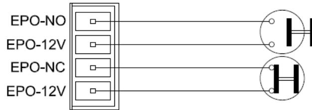
Verbindung zwischen dem Taster und dem REPO-Anschluss der USV.
