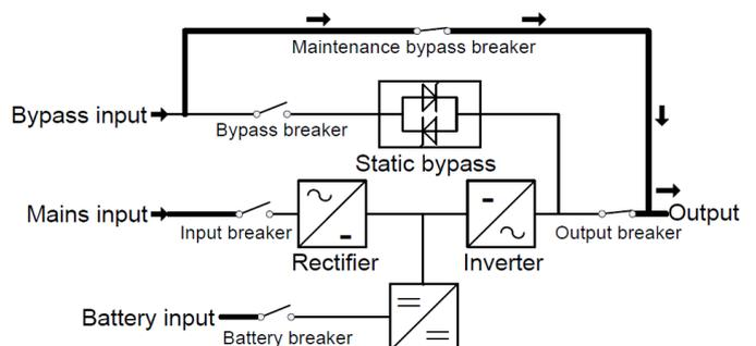
◆ **Paralleler Redundanzmodus (Systemerweiterung)**
